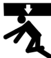
**ВНИМАНИЕ!** Нагрузка должна быть равномерно распределена по всей опорной площадке подъемника. Плунжерный поршень должен находиться точно на одной линии с движением груза. При использовании нескольких устройств для подъема груза все домкраты должны использоваться одновременно, чтобы груз поднимался равномерно. Неравномерный подъем может привести к соскальзыванию груза с опорной площадки.
